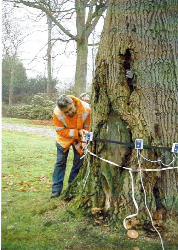
Een technicus van ARBORI is bezig met het uitvoeren van een picus-scan bij de bedreigde Moseik in het Cantonspark.
